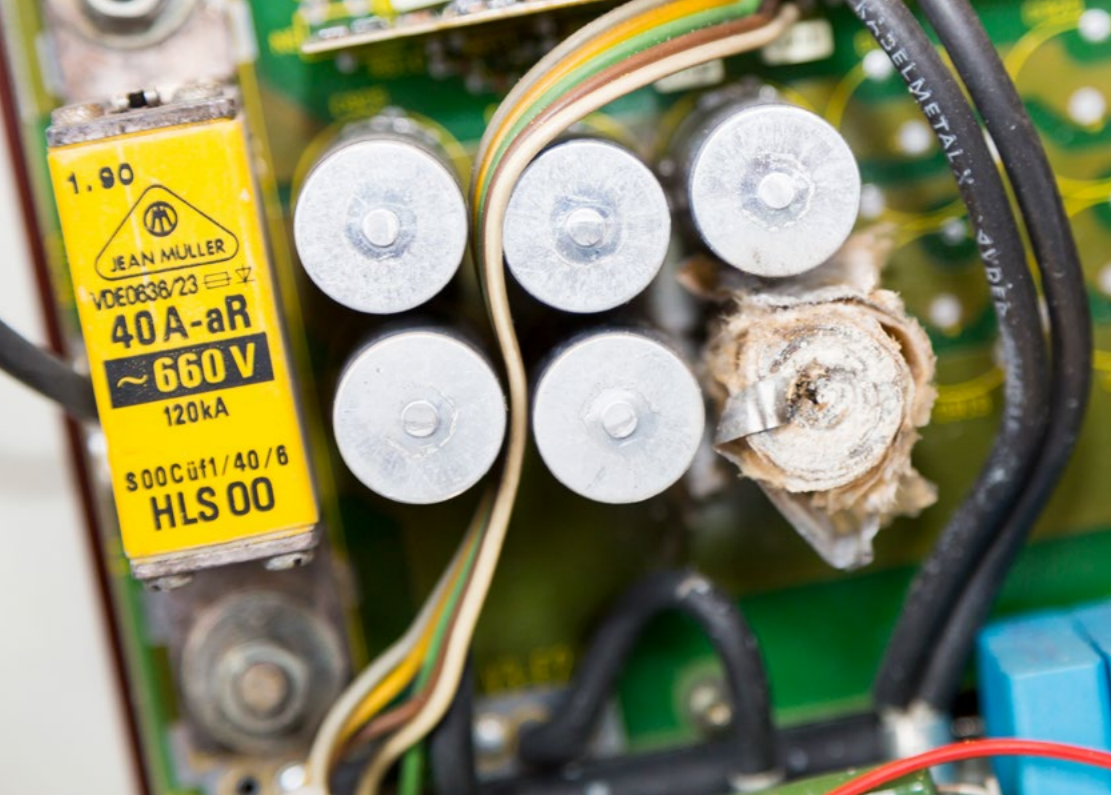
Werden Umrichter nach längerer Lagerdauer in der Anlage verbaut, kann es zu gefährlichen Explosionen kommen.
