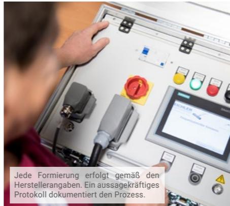
Werden Umrichter nach längerer Lagerdauer in der Anlage verbaut, kann es zu gefährlichen Explosionen kommen.
