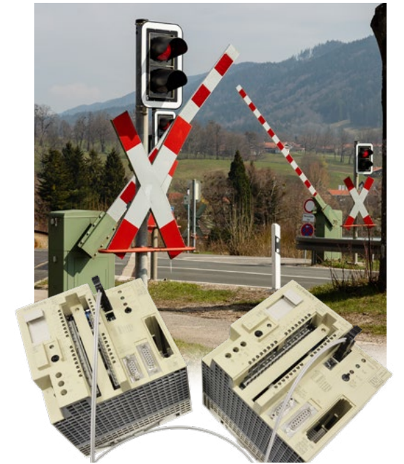
Pro Bahnübergang sind 2 sicherheitsgerichtete CPU Baugruppen des Typs S5-95F (6ES5095-8FB01) verbaut. Sie sind für sämtliche Funktionalitäten des Bahnübergangs zuständig. Die verbaute F-Funktionalität sorgt auch im Störfall für einen sicheren Zustand.
