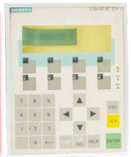
Wiederhergestelltes Gehäuse durch plastisches Remodulierverfahren
