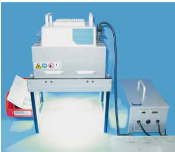
Aushärtungsgerät mit UV-Licht
